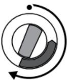
Stellen Sie den Schalter der Zeitschaltuhr in den Abschnitt "Vorwahl" (Abschnitt B in Abb. 2, 0–8 Stunden). Der Ofen beginnt zu heizen, wenn die Zeitschaltuhr den Schalter zurück in den Abschnitt "ein" gedreht hat. Danach bleibt der Ofen etwa vier Stunden lang an.
