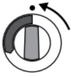
Der Ofen wird ausgeschaltet, wenn die Zeitschaltuhr den Schalter zurück auf null gedreht hat. Sie können den Ofen jederzeit selbst ausschalten, indem Sie den Schalter der Zeitschaltuhr auf null stellen. Schalten Sie den Ofen nach dem Saunabad aus. Manchmal ist es ratsam, den Ofen noch eine Weile weiter laufen zu lassen, um die Holzteile der Sauna richtig trocknen zu lassen.
